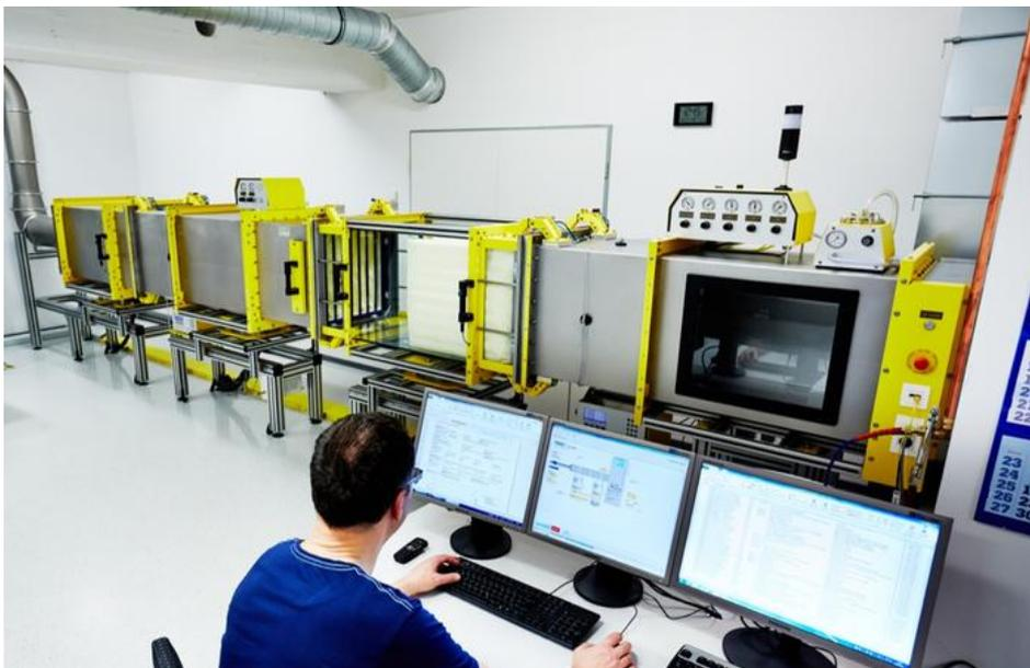
*Der Prüfstand zur Prüfung und Klassifizierung von Grob- und Feinstaubfiltern wurde nun um die Prüfmöglichkeit für Schwebstofffilter erweitert.*
